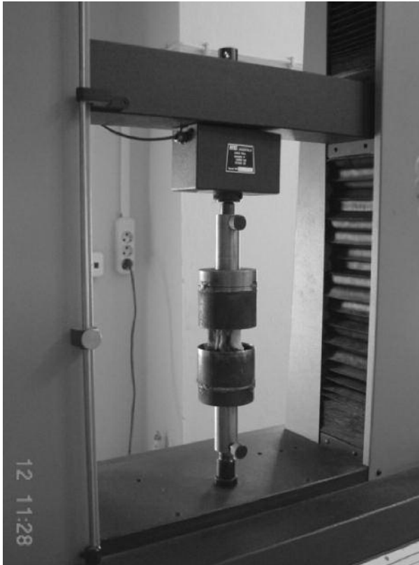
Şekil-5. Kemiğin bağlanması ve basma testi.
